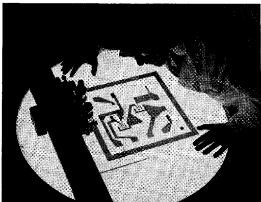
Het controleren van de werktekening voor een masker van een microcircuit, op honderden malen de ware grootte
